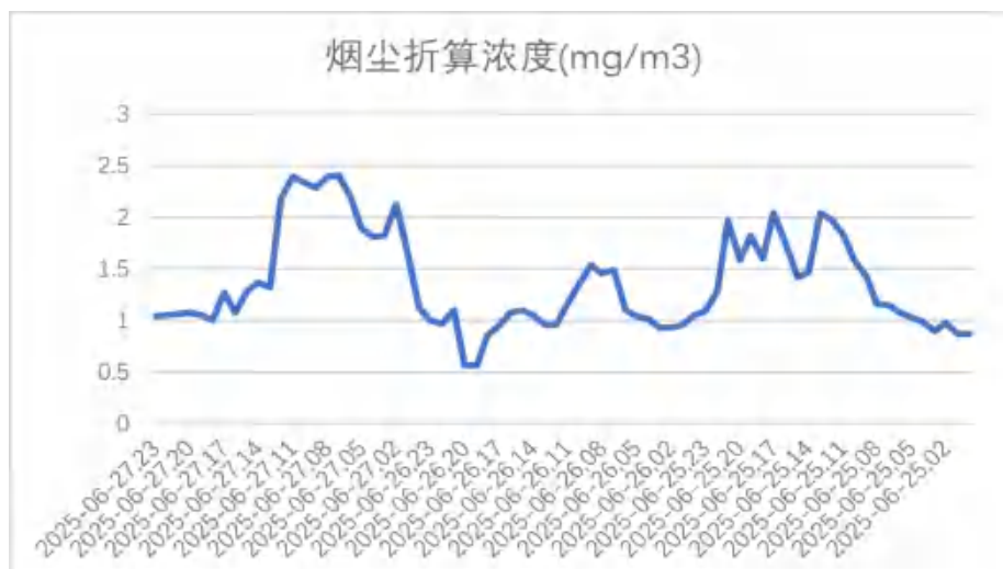
图 9.2.5-7 监测期间废气中烟尘的在线监测数据曲线图 (25.6.25~6.27)
