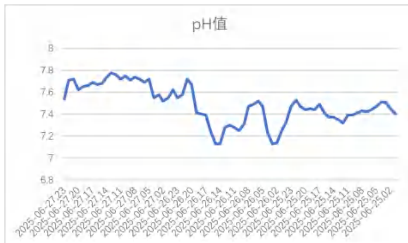
图 9.2.5-1 监测期间废水中 pH 的在线监测数据曲线图（25.6.25~6.27）
