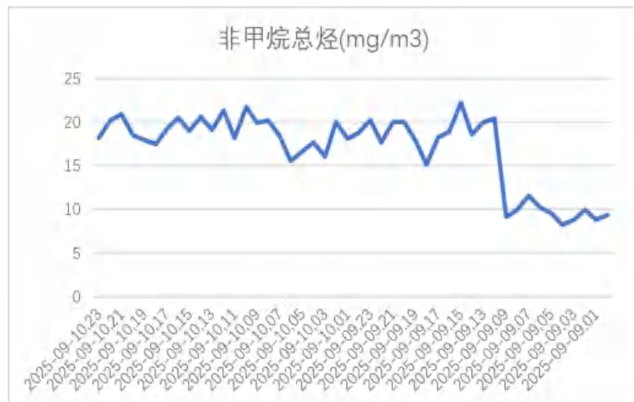
图 9.2.5-12 监测期间废气中非甲烷总烃的在线监测数据曲线图（25.9.9~9.10）
