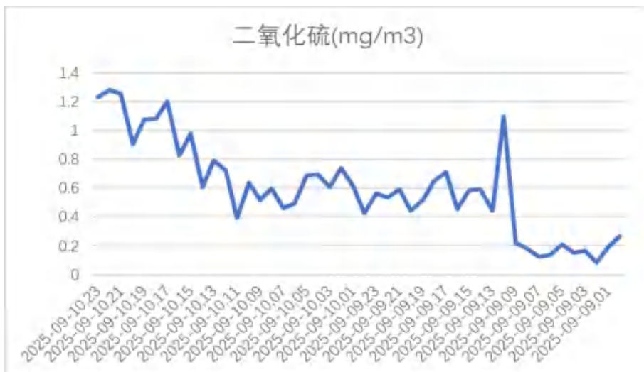
图 9.2.5-10 监测期间废气中二氧化硫的在线监测数据曲线图（25.9.9~9.10）
